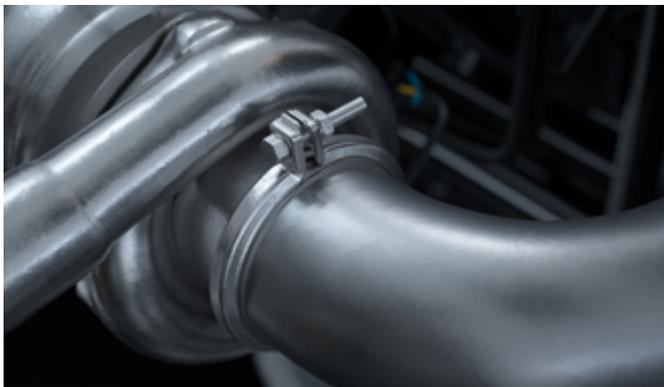
**VPP-Profil-Schellen** eignen sich hervorragend für den Einsatz bei Motoren mit Abgasturbo ladern und halten extremen Abgastemperaturen von bis zu 1.050 °C stand.
